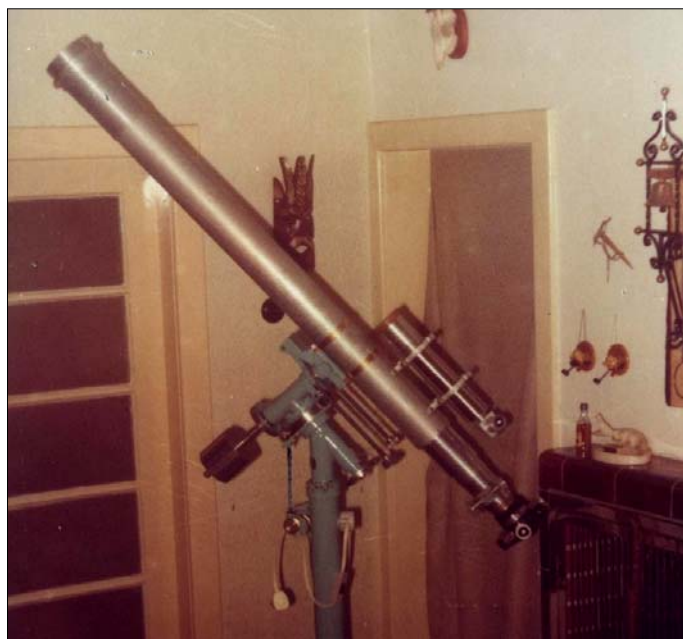
Refraktor 100/1500 mm, r.1987, optika prof. Ing.Gajdušek, montáž pan Kozelský. Dělené kruhy, pohon: motor grilu, okuláry 6 až 27mm.
