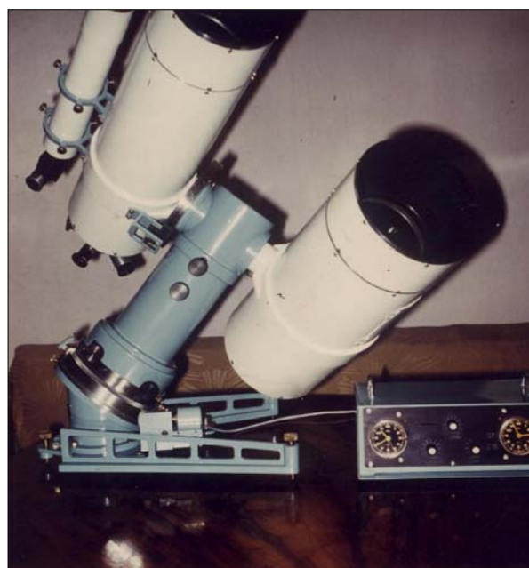
2x Maksutovova optika Vývojové optické dílny AsÚ ČSAV (Melich 1986) 160/2050 vizuální, 200/400 mm fotografický.
